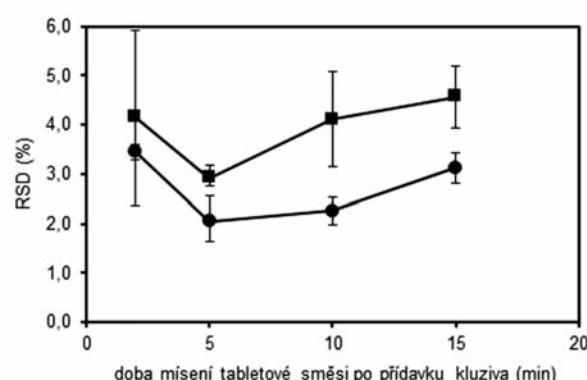
Obr. 1. Vliv doby mísení na obsahovou stejnoměrnost tabletových směsí (○) a tablet (■) s obsahem warfarinu sodné soli 5 mg; chybouvé úsečky znázorňují maximální a minimální hodnotu RSD v rámci připravených šarží
